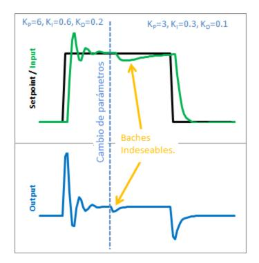
Los PID principiantes, de hecho, actúan de manera errática si queremos setear los valores de la sintonización, mientras el sistema está corriendo. Veamos por que. Aquí se muetra el estado del PID antes y después de que los parámetros han cambiado.
