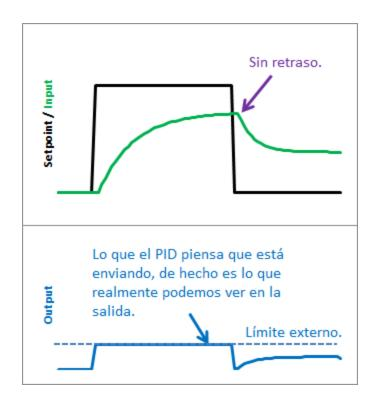
Como podemos ver el fenómeno del WindUp es eliminado. Además, podemos ver que la salida permanece dentro del rango que deseamos. Esto significa que podemos configurar el rango de valores máximos y mínimos que necesitamos en la salida.
