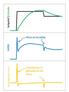
La imagen de arriba ilustra el problema. Siendo el *error* = *setpoint* - *entrada*, cualquier cambio en la consigna, causa un cambio instantáneo en el error; la derivada de este cambio es infinito (en la práctica, *dt* no es cero, igualmente, el valor termina siendo muy grande). Esto produce un sobrepico muy alto en la salida, que podemos corregir de una manera muy sencilla.
